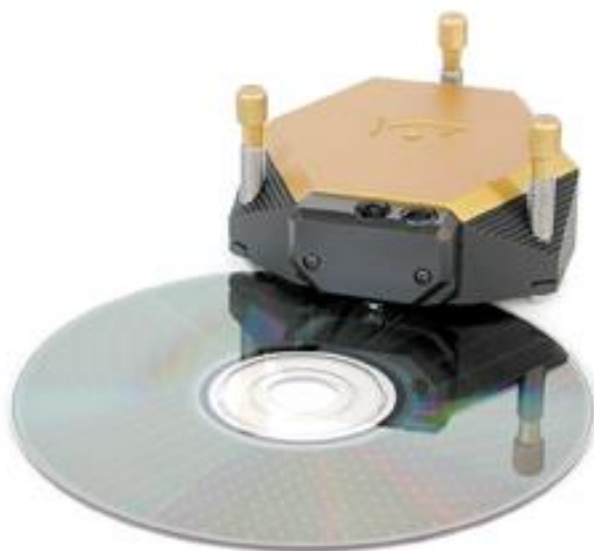
Joonis 2: CD-plaadi mõõtmised AFMi abil. 3-mõõtmelise pildi saab ligikaudu 10 minutiga. 5
